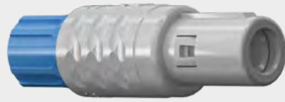
连接器 型式1 / 1号尺寸 / ODU MEDI-SNAP® 系列/ 定位0° / 连接器插头外壳 塑料, 灰色 / 绝缘体PEEK / 14芯 / 插针 (焊接) 镀金 / 端接面积AWG 28 / 线缆直径 5.3–6.5 mm / 标准螺帽, 蓝色
